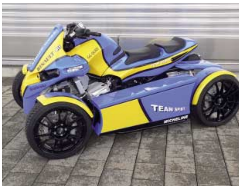
Quads/ATVs: Roller- oder Motorradantriebe in um Fahrwerke erweiterten Zweiradrahmen
